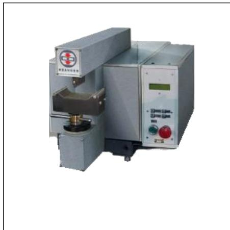
Прибор 2170 П-6 предназначен для испытания образцов из цемента на двухпорный изгиб при нормальной температуре.
